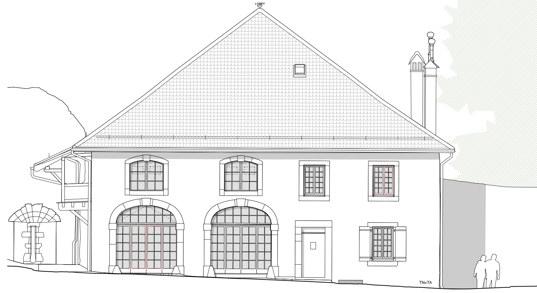
Maison du jardinier - Façade nord-ouest
