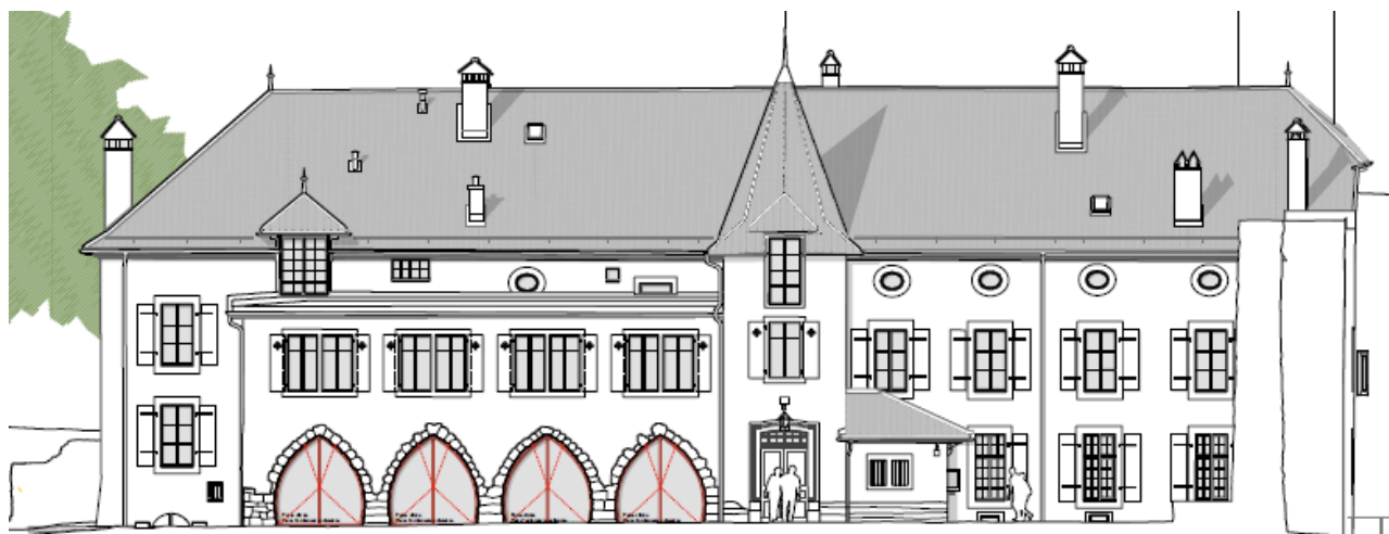
Vue de la façade coté cour avec le vitrage des arcades
