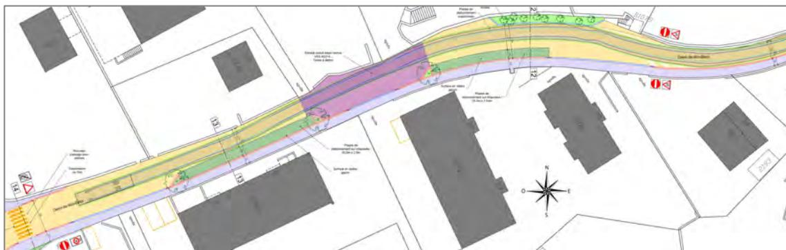
Figure 13 : Tests de giration, bus descendant sur le bas du chemin des Murs-Blancs
