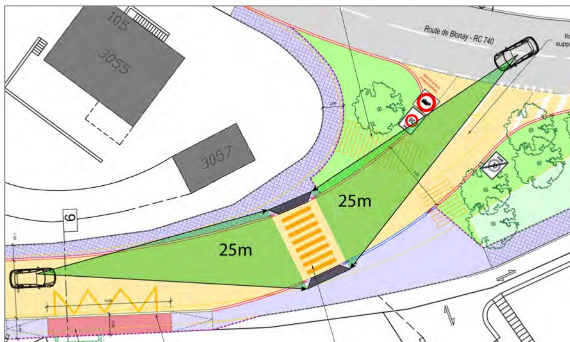
Figure 17 : Conditions de visibilité sur le passage piétons
