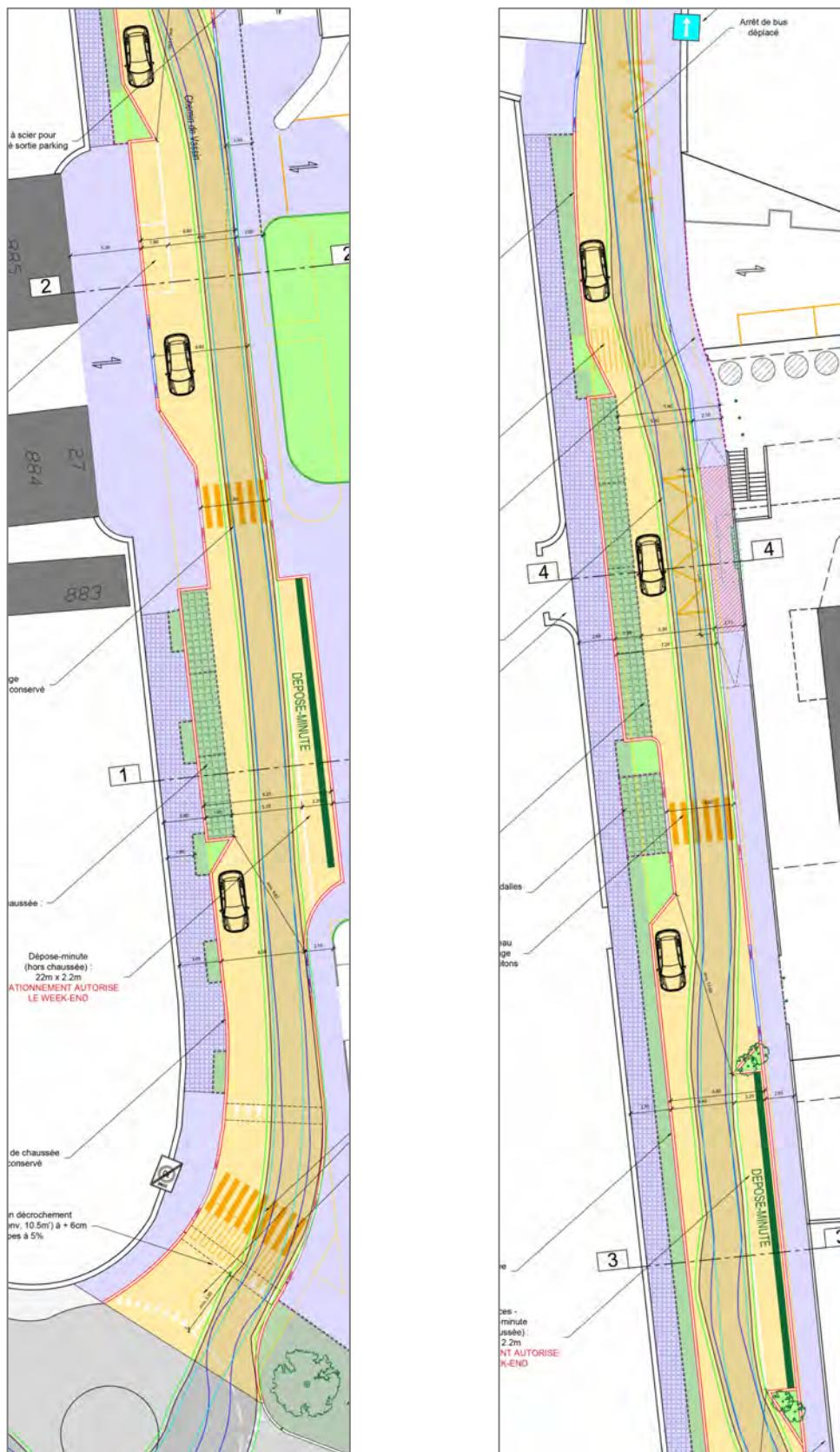
Figure 16 : Tests de giration, bus montant sur le chemin de Vassin
