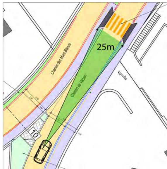
Figure 19 : Conditions de visibilité sur le passage piétons
