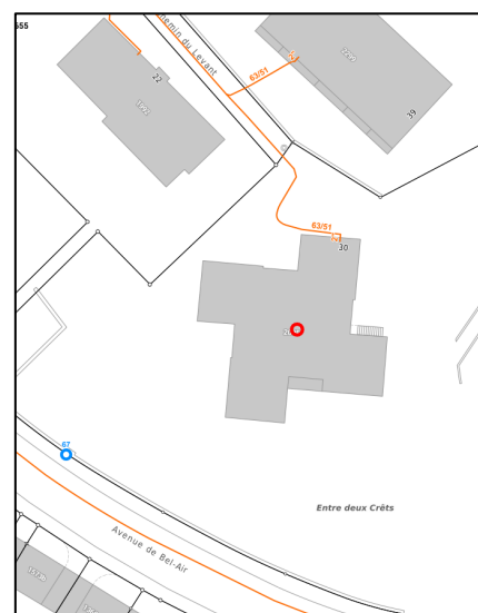
Arrivée du gaz existante – Pavillon de Bel-Air
