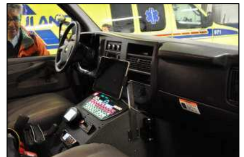
Photo 2.2 – Tableau de bord Ambulance CSU avec matériel de navigation
